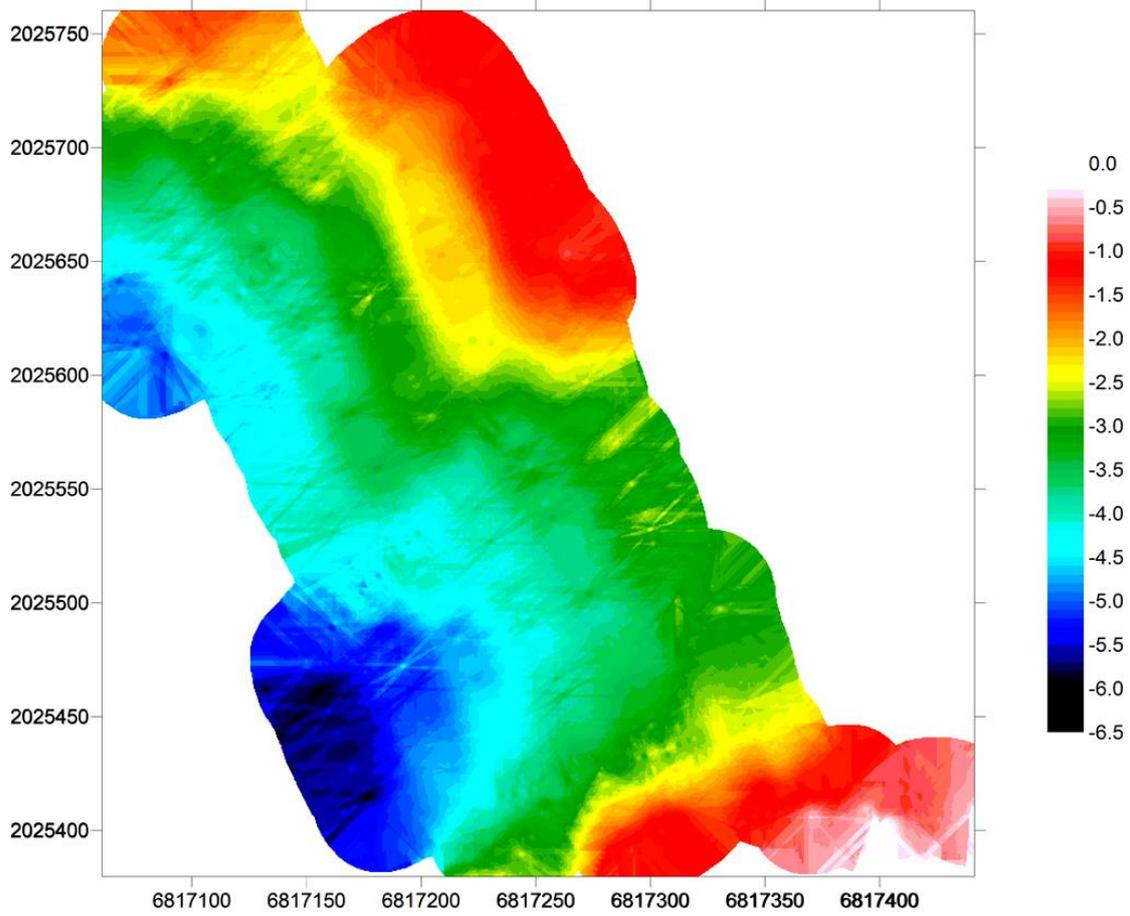
单波束测深仪测量湖泊水底结构二维平面图
