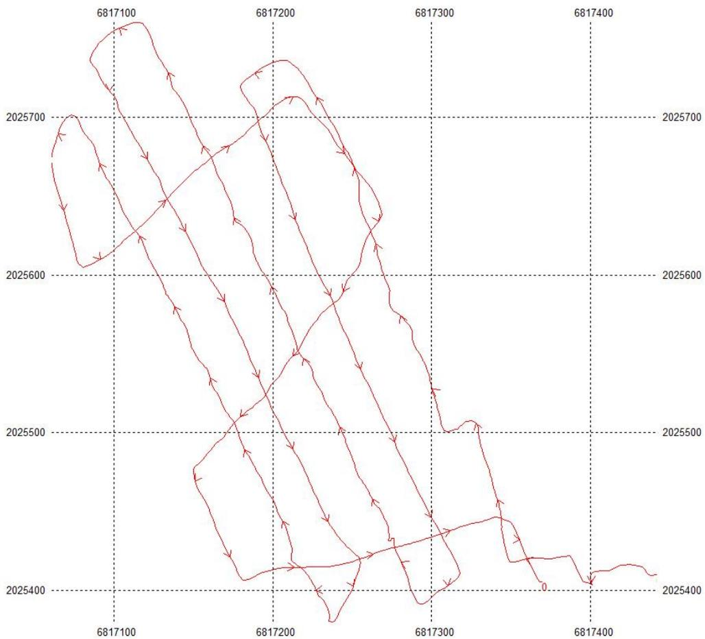
单波束测深仪测量湖泊水底结构航迹图
