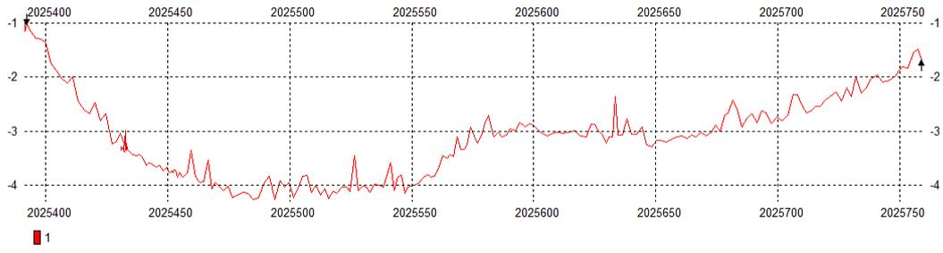
单波束测深仪测量湖泊单条测线水深曲线图资料
