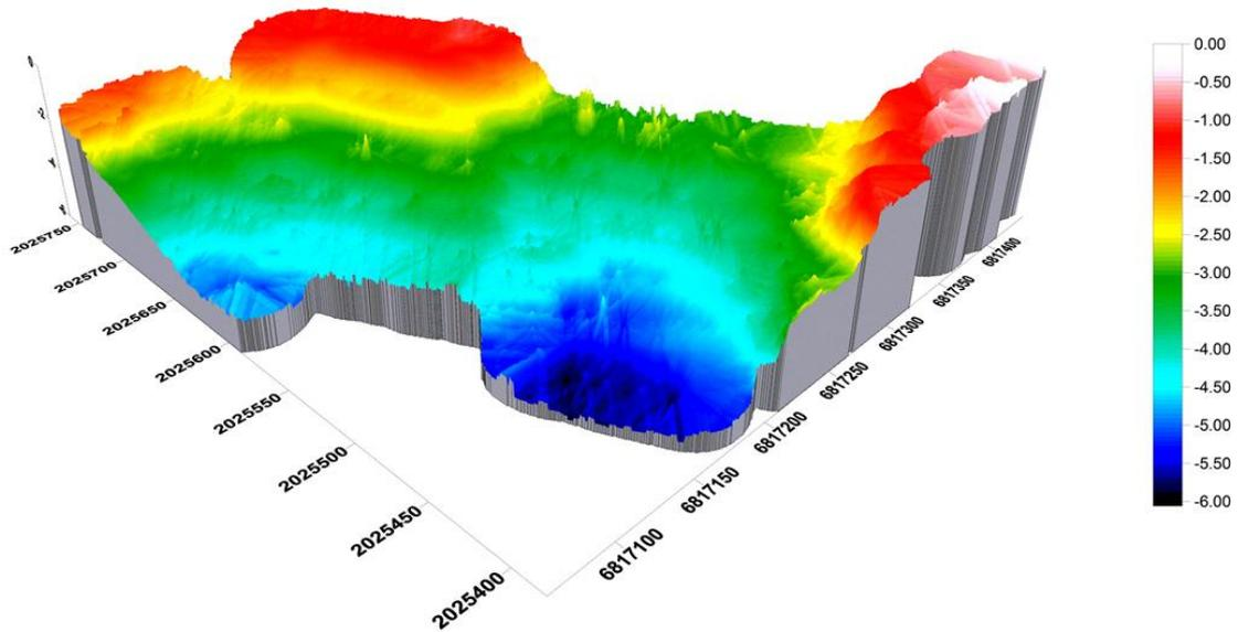
单波束测深仪测量湖泊水底结构三维立体显示图
